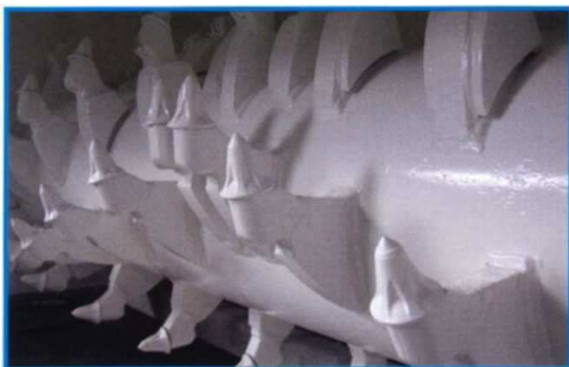
Rotor SBF 24 Rotorové zuby s hriadeľom 25 mm
