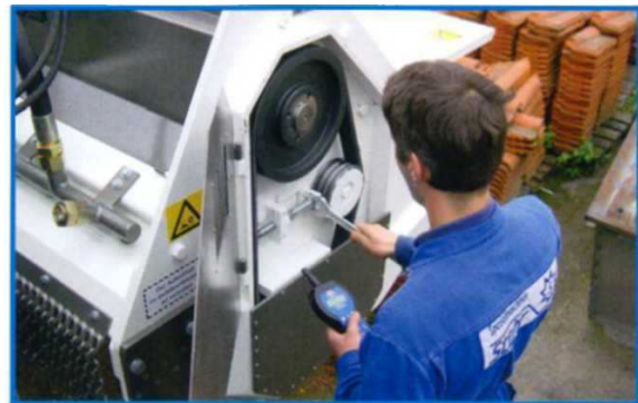
Zvláštna výbava: nastavenie napnutia remeňa pomocou zariadenia na meranie frekvencie OPTIBELT
